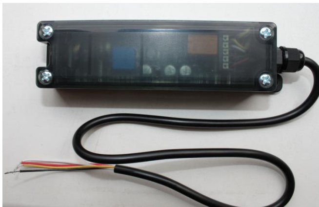
Приемник «чувствительной кромки» WDD Красный - «+24 DC» Желтый* Черный « - Общ.» Белый «Сигнал, Управл. NO»
