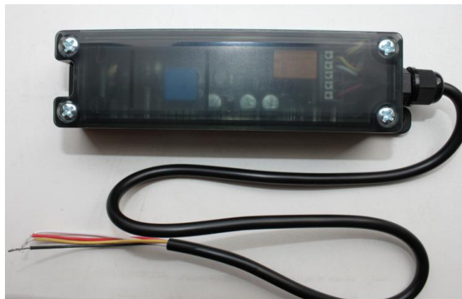
Приемник «чувствительной кромки» WDD Красный - «+24 DC» Белый* Черный « - Общ.» Желтый «Сигнал, Управл. NO» NC – подключить дополнительно*
