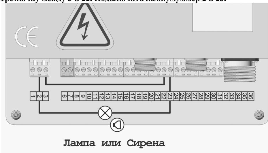
**10.13 Подключение сигнальной лампы или зуммера питание 24В.**
