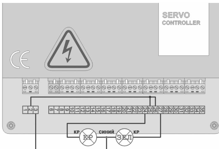
**10.12 Подключение сигнальной лампы или зуммера питание 220В.**
