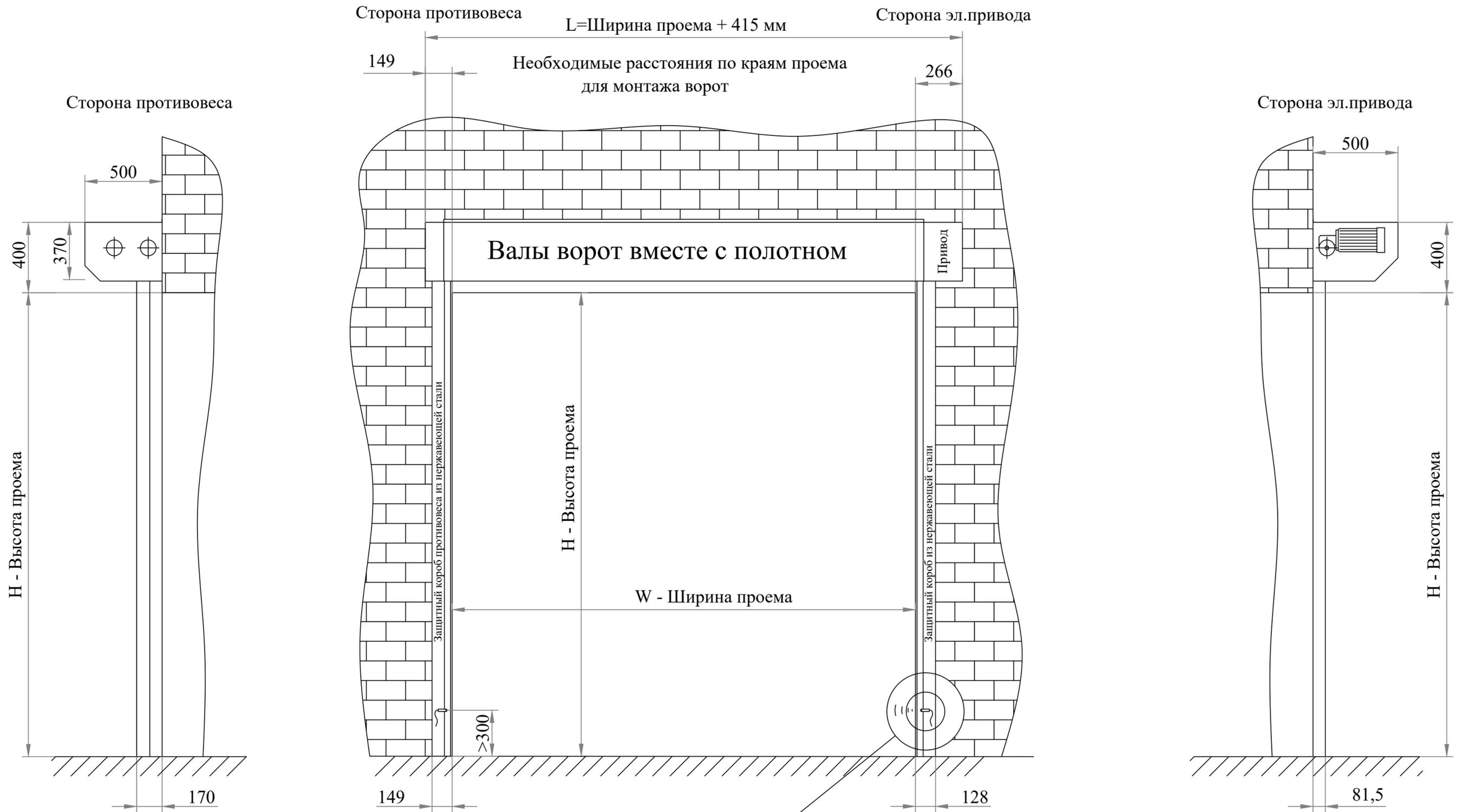
Ворота DoorSpeed XHF F-DZ FREEZE -30C устанавливаются через проставку (утеплитель/отсекатель входит в состав комплекта). Толщина проставки 10мм. Вся конструкция ворот отодвинется от проема по плоскости примыкания на 10мм.
