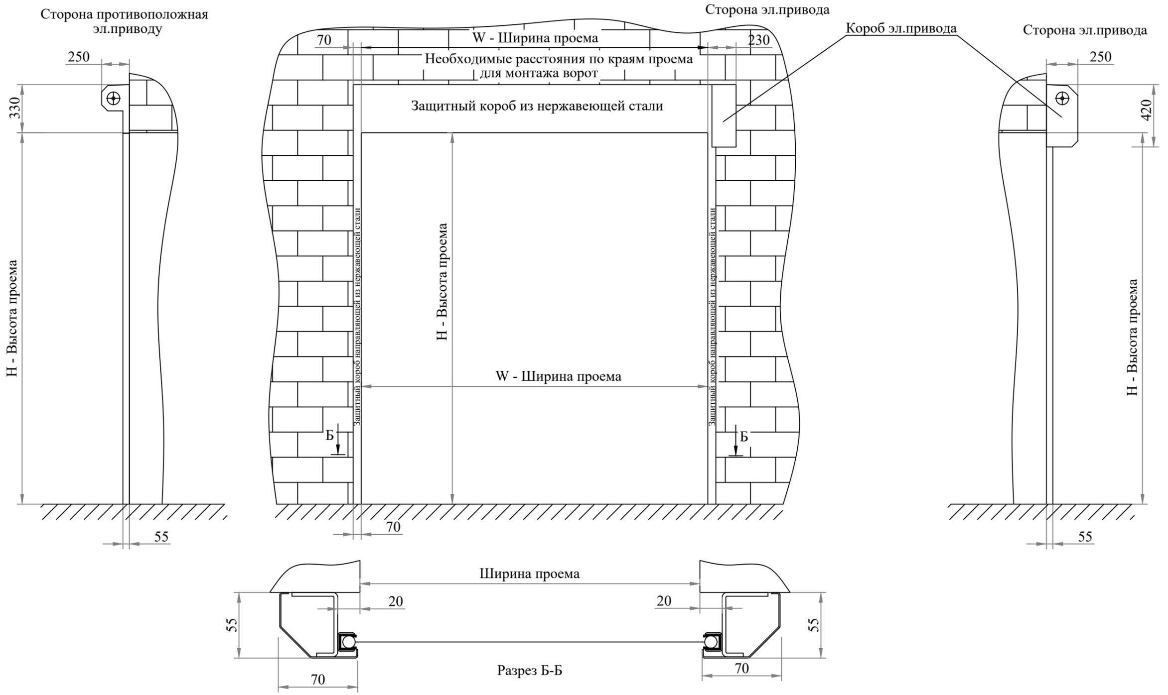
1. Двигатель справа. Двигатель слева - зеркальное отображение двигателя справа. Расположение двигателя определяется проектом согласно технических размеров проема.
